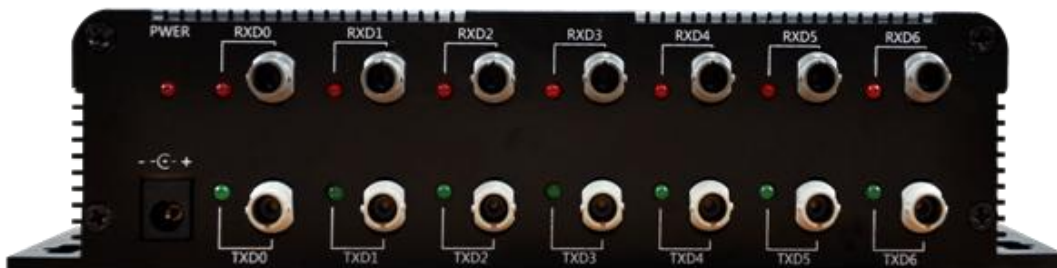
图 1 虚拟仪器的高速数据采集器_DH2000 数字主机的背板 AnyBus 高速串行光纤总线接口
