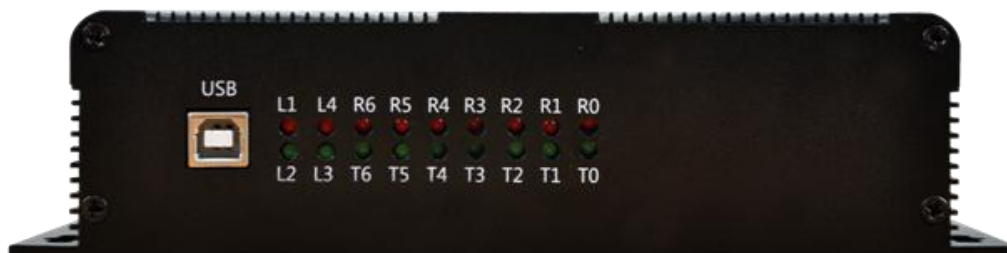
图 2 虚拟仪器的高速数据采集器_DH2000 数字主机的前面板 USB 接口及通讯指示灯
